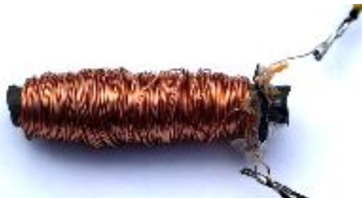
*Electroaimant fabriqué par bobinage*
