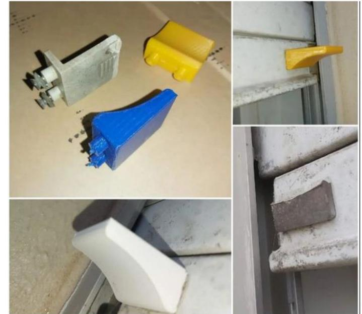
Impression 3D et économie circulaire ♻️ c'est aussi à ça que sers #LaFabrique ! Voici un projet de réparation d'un support pour volet modélisé et imprimé en 3D par Yoann 🧡
